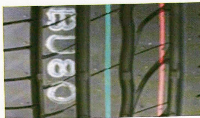
**T.W.I:** Resolução Nº 558, de 15/04/1980, do Contran - Conselho Nacional de Trânsito, os pneus devem ser fabricados ou reformados com indicadores de desgaste (TWI – Tread Wear Indicator), colocados no fundo do desenho da banda de rodagem, que demonstram que o pneu atingiu o limite de desgaste permitido, estabelecido pela própria norma, que é de 1,6 mm.
